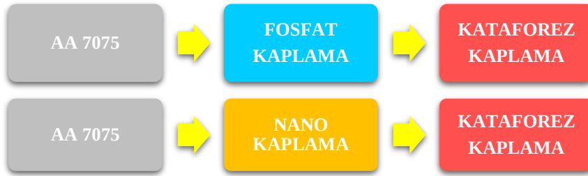
Şekil 1: Altlık yüzeyine uygulanan işlemlerin akış şeması
