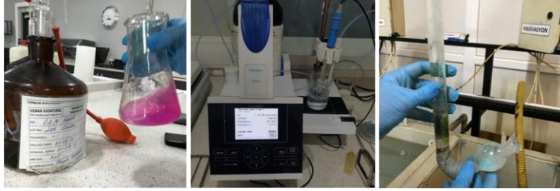
Şekil 3: Fosfat banyo analizi
