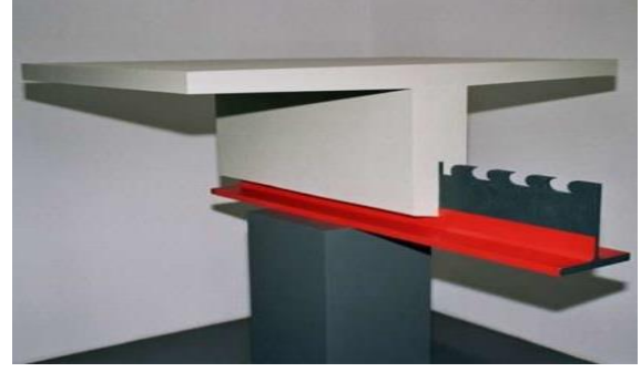
Şekil 3: T-profillerin kısa açıklı kompozit köprü sistemlerde kiriş olarak kullanımı (a) Kompozit Çelik T-Profilli Beton Tabliyelı Köprü Sistemi (Naito, Hendricks, Sause, & Cercione, 2021) (b) Precobeam kompozit köprü sistemi (Lorenc, Seidl, & Berthelley, 2022)
