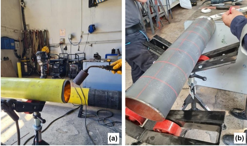
Şekil 4: İş parçası hazırlıkları: a) PE izole kılıf soyulması ve b) 200 mm uzunluklarda kesme işlemi
