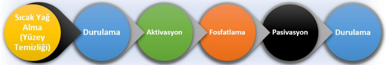
Şekil 1: Fosfatlama işlem basamakları
