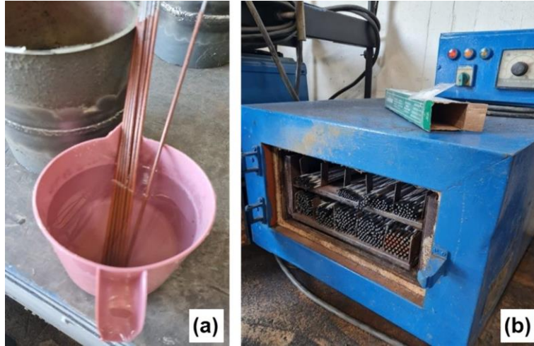
Şekil 3: Elektrot şartlandırması: a) elektrot nemlendirme-kirletme ve b) TİT marka elektrot ısıtma fırınında kurutma
